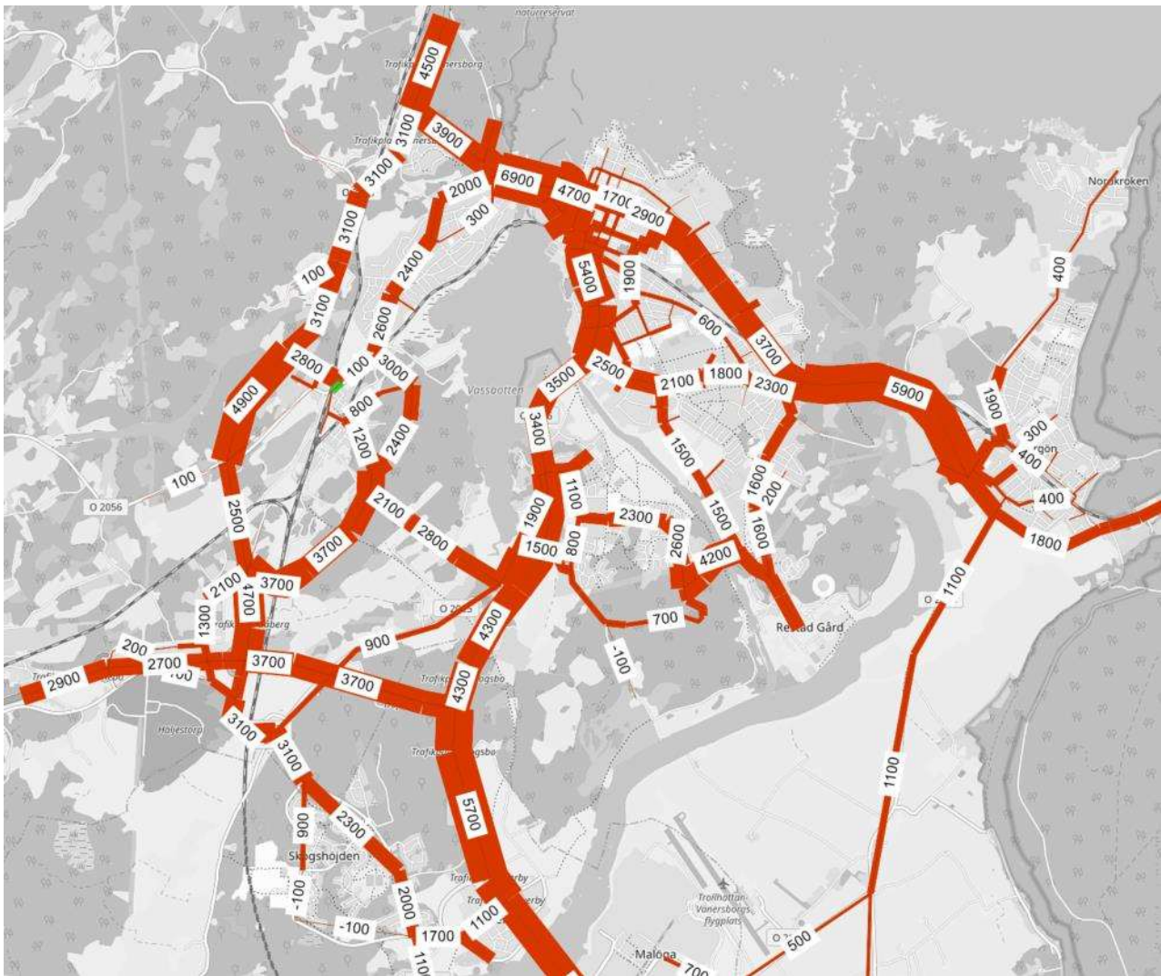
Figur 12 Differensbild som visar skillnad i trafikmängder för Bostadsscenario Full utbyggnad med vägutbyggnad enligt alternativ V4 jämfört med nuläget. Röd färg visar trafikökning, grön färg visar trafikminskning.
